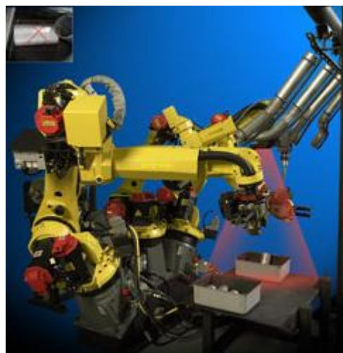
Obr. 9: Montáž tlmičov výfuku (Prehn, 2010)
